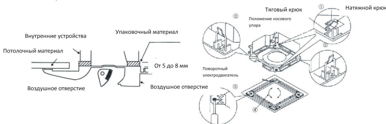
**⚠ ВНИМАНИЕ!** Не закручивайте провода поворотного двигателя в уплотняющую губку.
