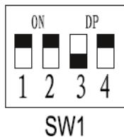
Если устройство оборудовано индикаторной панелью с цифровым дисплеем, переведите четвертый переключатель SW1 в положение DP на электронной системе управления внешнего блока, как показано на рисунке слева:
