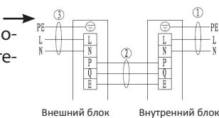
Применимо для моделей KF-MCA24, KF-MCA36, KF-MCA48 и KF-MCA60 с трехфазным охлаждением и тепловым насосом
