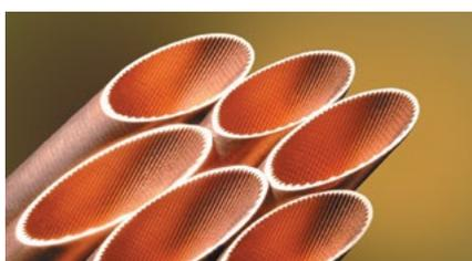
Медная труба с трапециевидной внутренней канавкой увеличивает поверхность теплообмена на 20-30%, повышая эффективность обогрева и охлаждения на 10-20%.
